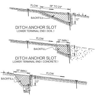
DITCH ANCHOR SLOT UPPER TERMINAL END (SOIL)
